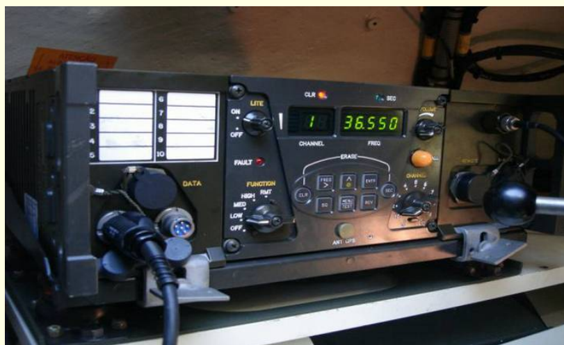
VRC-120 S instalado na VBC
